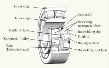
(d) Spherical roller bearing
